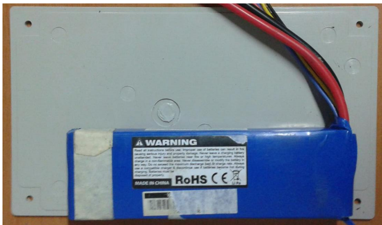
Figura 34 - Tampa da caixa com bateria fixada
