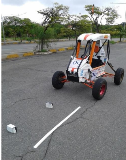
Figura 49 – Teste de calibração dos sensores de velocidade
